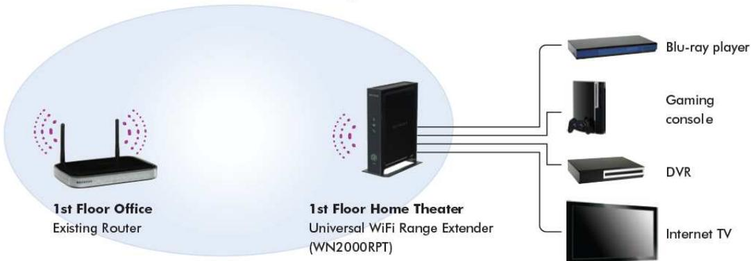
Sie können Szenario 1 und 2 gleichzeitig einsetzen: Der WN2000RPT kann gleichzeitig als Brücke und als Reichweiten-Maximierer fungieren. Bei einem solchen Einsatz könnte die Wireless-Performance allerdings geringer ausfallen.
